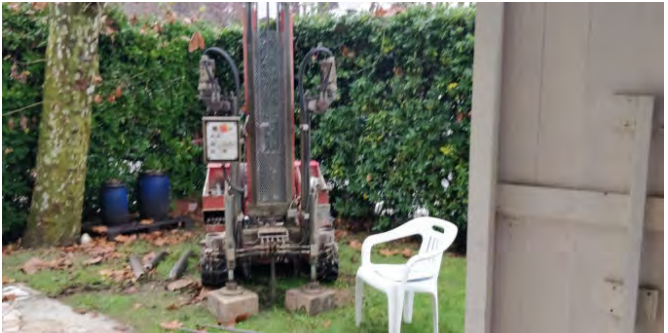
Figura 2 INDAGINE PENETROMETRICA DPSH1 ESEGUITA SUL SITO
