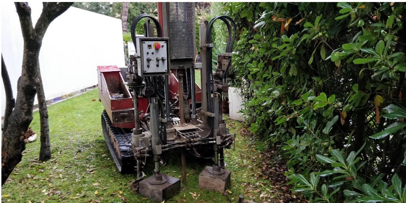
**Figura 5** INDAGINE PENETROMETRICA CPT1 ESEGUITA SUL SITO
