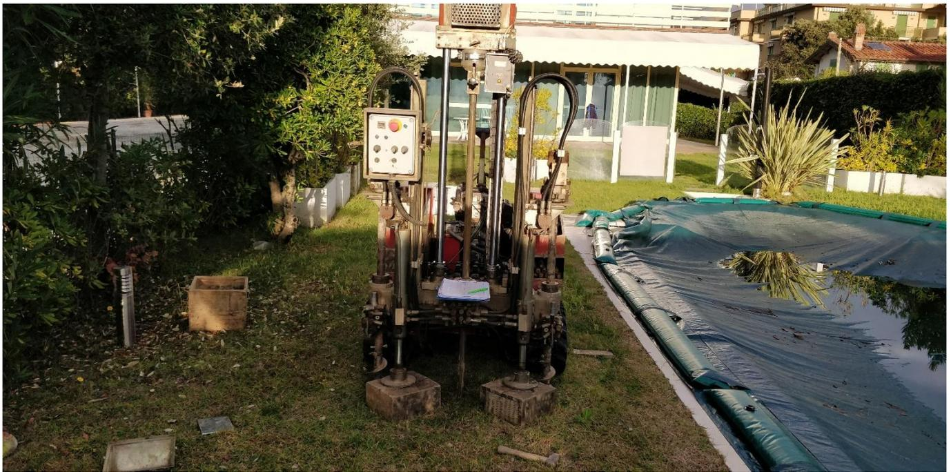
*Figura 7 INDAGINE PENETROMETRICA CPT3 ESEGUITA SUL SITO*
