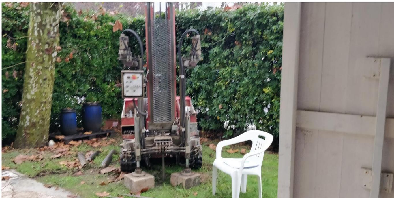
Figura 8 INDAGINE PENETROMETRICA DPSH1 ESEGUITA SUL SITO
