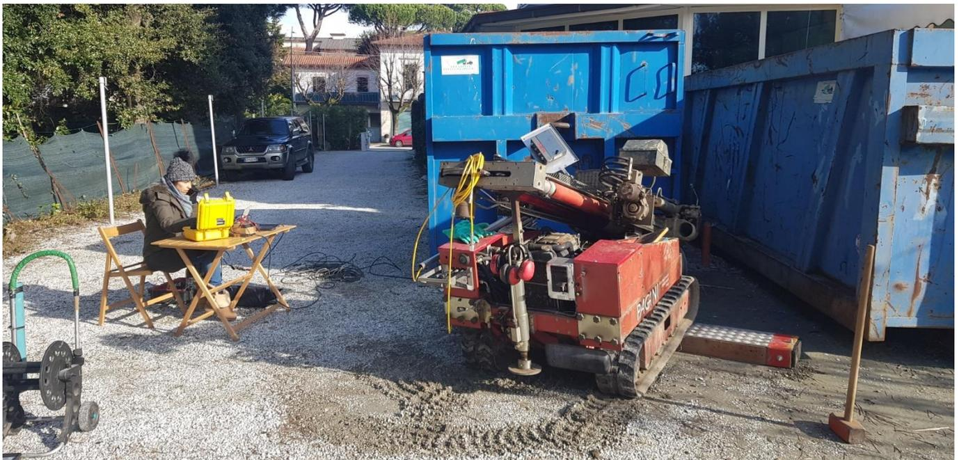
Figura 9 ESECUZIONE PROSPEZIONI SISMICHE IN FORO
